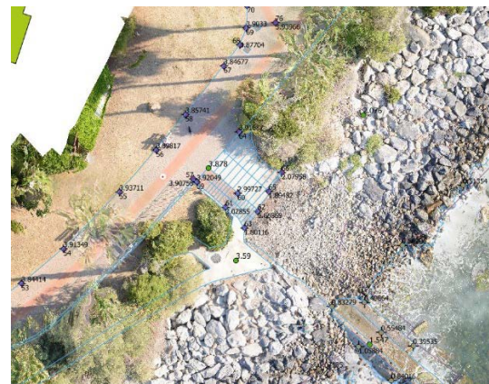
Sovrapposizione ortofoto e quote estratte da DEM Overlapping orthophotos and quotas extracted from DEM
